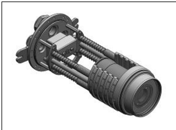
Abbildung 39: Frontaufsatz mit Pyrometer im Chassis
