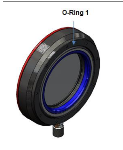
Abbildung 30: O-Ring 1 in Freiblasvorsatz einsetzen
