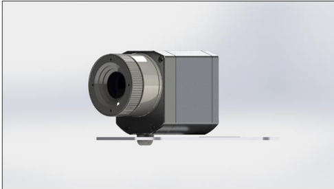
Abbildung 13: Montierte PI Kamera am Befestigungsblech
