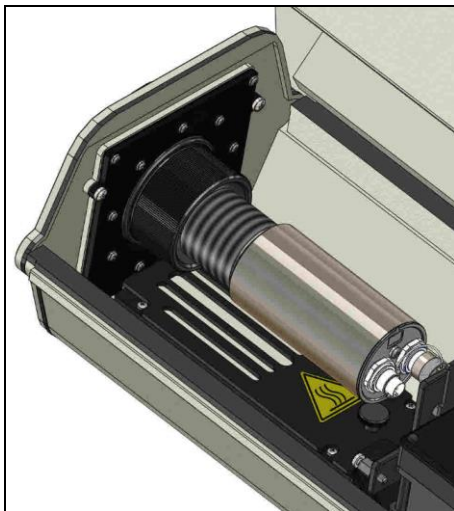
Abbildung 15: Xi Kamera in Adapterplatte schrauben
