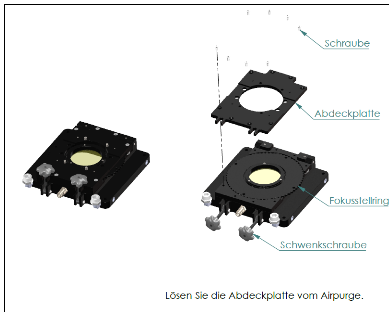
Abbildung 26: Montage des laminaren Freiblasvorsatzes
