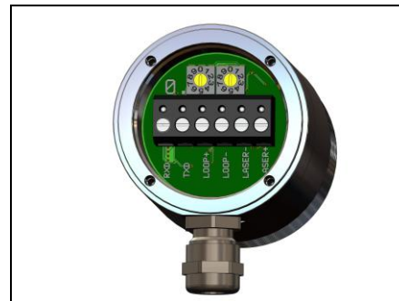
Sensorrückseite mit Anschlussklemmen
